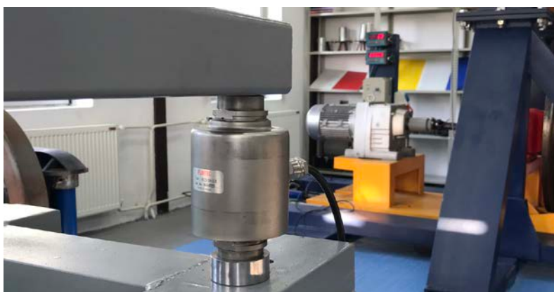
Слика 7.6 - Приказ динамометра и дигиталног дисплеја за мјерење допунске силе
