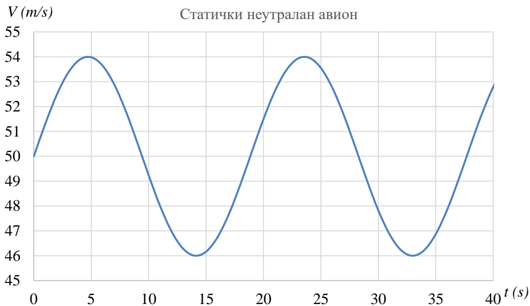
Слика 7 Статички неутралан равнотежни положај
