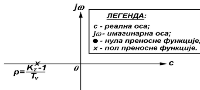
Сл. 19. ПН-дијаграм осцилаторне транспортне платформе која врши сепарацију влажне земљишне масе
